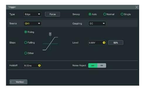
Figure 8.3 Edge Trigger Setting Menu
